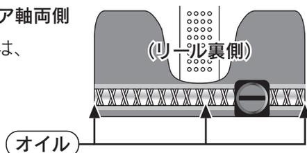
YARIIKA SPはベアリングが多数入っております。クロスギア軸両側にもベアリングが入っていますので、水道水で洗浄された後はしっかりとオイルを噴霧してください。
