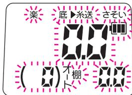
作動した際は、モーター保護のためモーターをON・OFFせずに5分以上休ませてください。(この際、ハンドルで糸を巻いたり、クラッチを切って糸を出したりしても糸巻学習は保持され、カウンターは正常に働きます。) 点滅が点灯になればブレーカーは復帰です。
