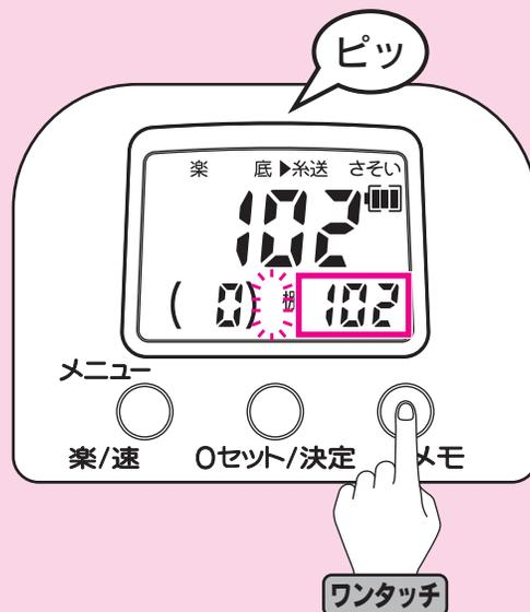
シカケをメモリーしたい水深(6.1m以上)に合わせ、メモボタンを押します。「オート」の表示が消え、上図ですと10.2mの水深がメモリーされます。(□部分)
