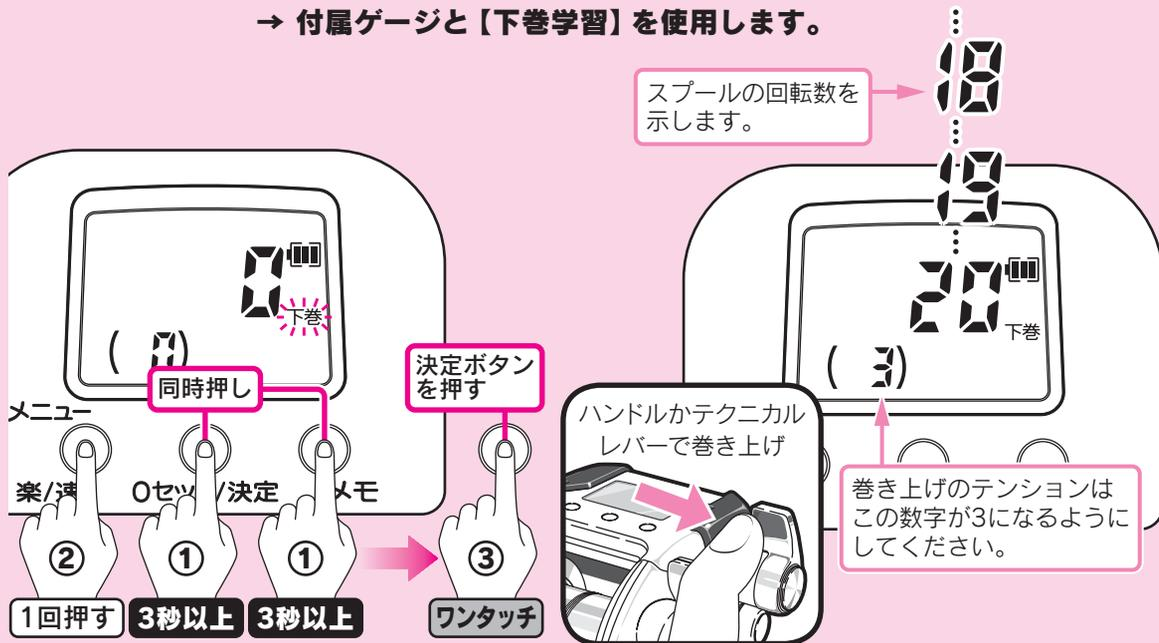
**1** カウント値が6m以下で操作します。6.1m以上の時は0セット (29～30ページ参照) しておきます。決定ボタン、メモボタンを両方向同時に3秒以上押し、学習モードに入り、メニューボタンを1回押してください。「下巻」(下巻学習) が点滅し、表示は図のようになります。決定ボタンを押し、下巻学習を決定します。「下巻」が点灯に変わります。(学習モード内での学習方法の選択について、詳しくは15ページ「学習方法の選択」をご参照ください。)
