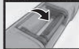
レバーを引き上げて開き、レバーを押し下げてロック。
