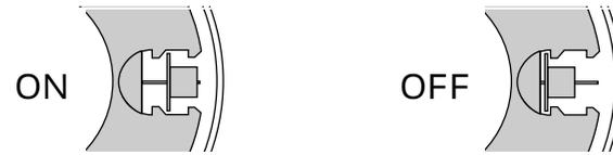
パーツケースの中に、リールに組み込まれている大きさと同じブレーキブロックを付属しています。この“SVS”によりルアーのウエイト、空気抵抗、そして、風のフォロー、アゲインストなど、さまざまな釣場状況に応じて適正なブレーキ力をつけることが可能となり、バックラッシュなしの遠投ができます。メーカー出荷時には、ブレーキブロック2個を“ON”の状態に設定しています。お買い求めいただいて、糸を巻き、このリールではじめてキャストするときには、6個のブレーキブロックをすべて“ON”にすることをおすすめします。その後“ON”のブロック数を調整してください。通常は、2~3個のブレーキブロックを“ON”の状態にしておくのが適切です。
