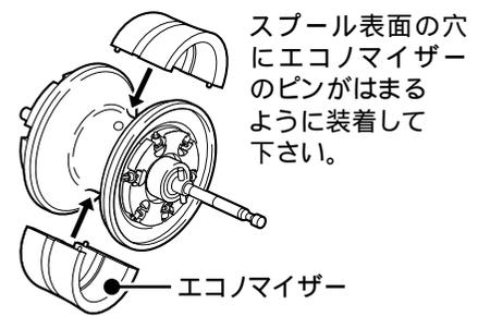
スプール表面の穴にエコマイザーのピンがはまるように装着して下さい。
