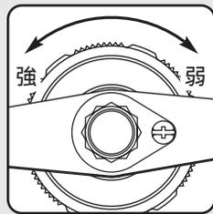
ブレーキは糸の送り出し方向にのみ働きます。従って巻き上げは、ブレーキの強弱に関係なく、直結で行えます。
