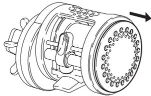
3. 左サイドプレートが回転し、内部機構が現れます。また、左サイドプレート内側に透明の防塵シールドを設けることで、砂・ゴミの侵入を防ぐ構造になっています。
