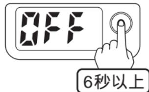
ボタンを6秒以上押し続けてください。「OFF」が表示された後、指を離せば液晶が消灯します。糸巻き学習の途中でキャンセルしたい場合にも一旦OFFしてください。約2時間リールを動かさないと、自動的にOFFになります。
