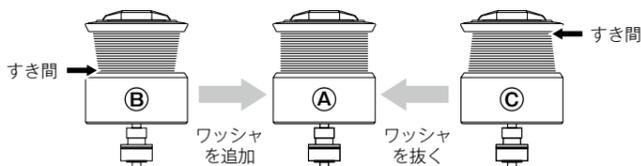
Bの状態からスプール調整ワッシャを追加するとAの状態に近づきます。Cの状態からスプール調整ワッシャを抜くとAの状態に近づきます。なるべくAの状態での使用をお勧めします。
