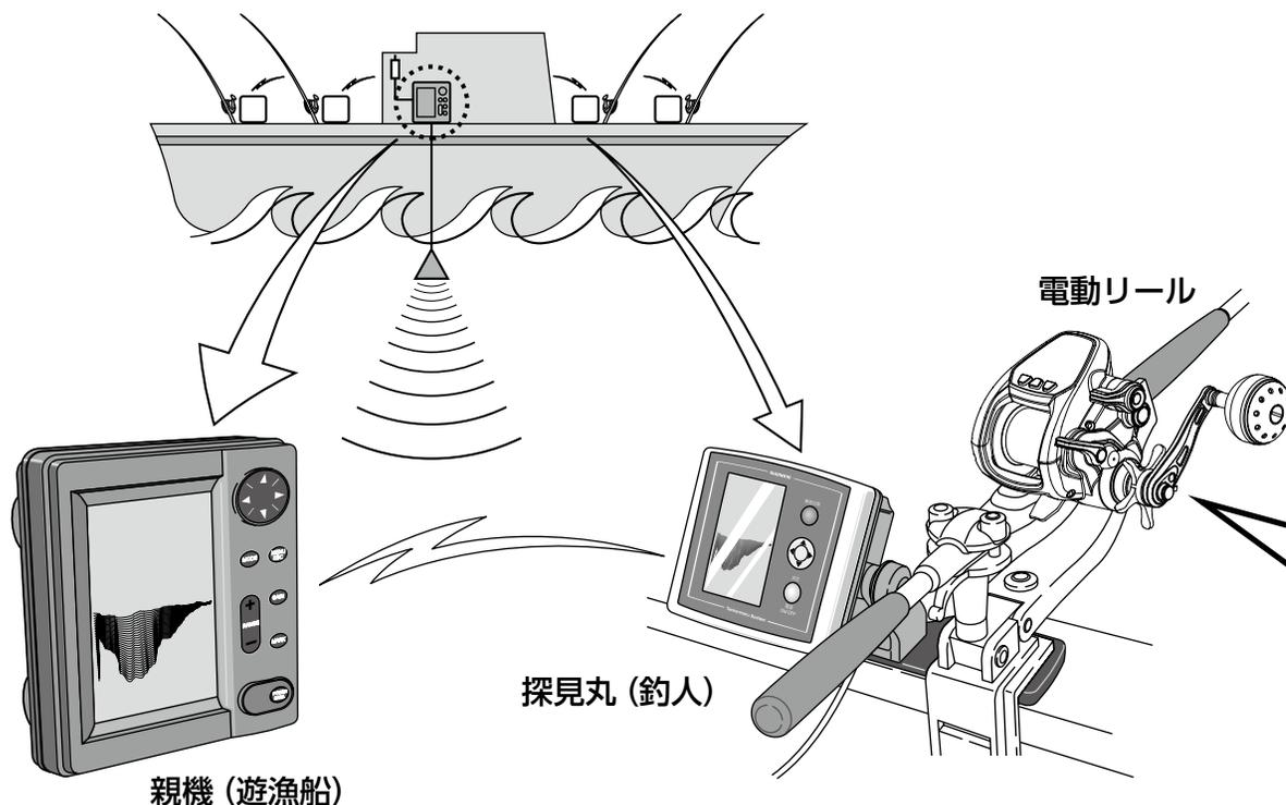
さらに探見丸システム対応電動リールと組み合わせることで、双方向に通信が可能となり、使い勝手が広がります。
