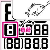
モーター巻上げ時、ラインテンションの目安を表示します。ドラッグ調整や、巻き上げスピードの調整などでハリス切れを防ぐことができ、また、魚の匹数や大きさの目安にもなります。
