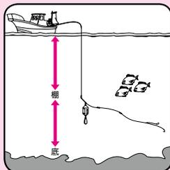
釣場、釣り方、対象魚など場合に依りて底からの水深を確認したい場合、メモ水深の表示方法を切り替えできます。上からモード時はメモ水深を表示していますが、底からモードを選択するとメモ位置を0とした水深が確認できます。
