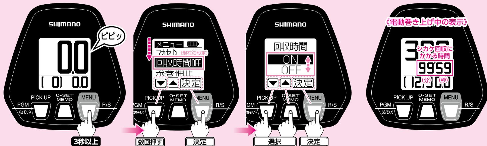
**1** 出荷時は仕掛回収時間OFFで起動します。図の水深表示はOFFになっている場合の例です。水深画面でMENU(メニュー) ボタンを3秒以上押すとメニュー画面が表示されます。
