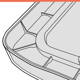
本体内部に補強リブを設け、ボディ全体の強度を大幅にアップ。合わせて、軽量性も両立しました。
