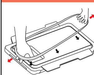
不能在橡胶垫圈安装的状态下直接清洗。请取下橡胶垫圈后使用中性和洗涤剂清洗。拆装的时候请务必调整橡胶垫圈的整体平衡。
