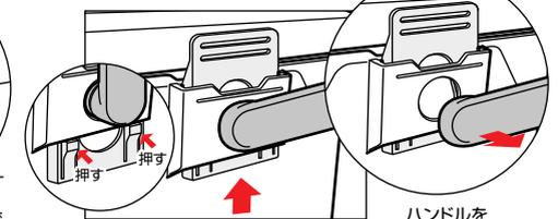
留め具をストップバーでロックがかかるまで押し下げます。ストップバーを押しながら留め具部分を上方へ押し上げます。ハンドルを取り外します。
