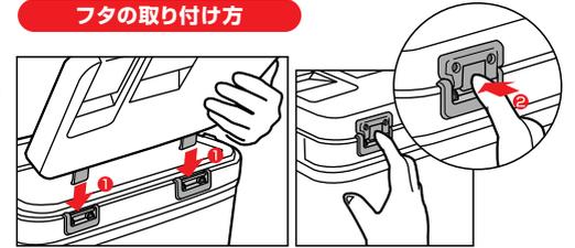
左右のジョイント部を本体部にセットし、ロックを押し込むだけで取り付け完了です。
