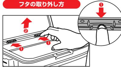
内部のレバーのロックをOFFにして簡単に取り外せるので、洗いやすく釣行後のメンテナンスが快適です。
