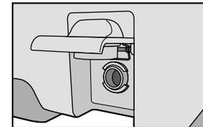
内部の水をワンタッチで簡単に抜ける水栓を採用しています。
