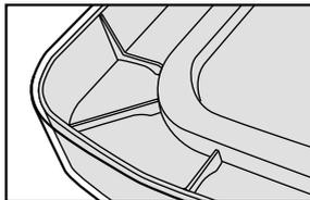
本体内部に補強リブを設け、ボディ全体の強度を大幅にアップ。合わせて、軽量性も両立しました。
