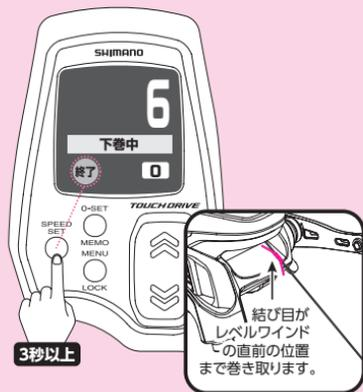
**4** 上図のようにハンドルで結び目まで巻き取ると、上図の画面になりますので、SPEED SET ボタンを3秒以上押ししてください。
