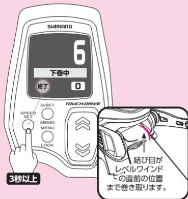
4 上図のようにハンドルで結び目まで巻き取ると、上図の画面になりますので、SPEED SETボタンを3秒以上押してください。
