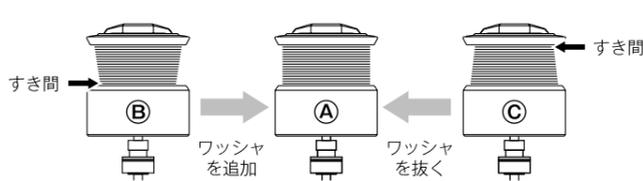
Bの状態からスプール調整ワッシャを追加するとAの状態に近づきます。Cの状態からスプール調整ワッシャを抜くとAの状態に近づきます。なるべくAの状態での使用をお勧めします。
