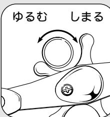
ロッドを水平にしてクラッチを切り、ルアーがゆっくりと落ちていいく程度に調整します。
