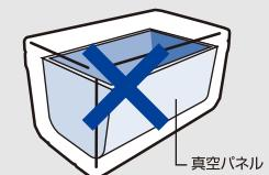
※フィクセルプレミアム、フィクセルリミテッド、スペーザリミテッドは断熱素材として真空パネルを使用しています。ネジでの固定ができない場合があります。
